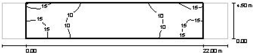
Figura 5.15 – Illuminamento orizzontale medio – curve isolux.
