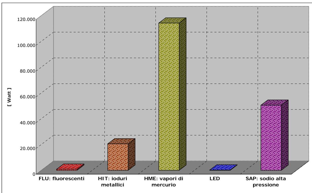
Figura 4.4 -Potenza elettrica impegnata per le varie tipologie delle sorgenti luminose.
