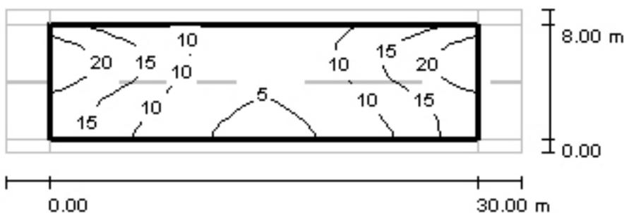
Figura 5.13 – Illuminamento orizzontale medio – curve isolux.
