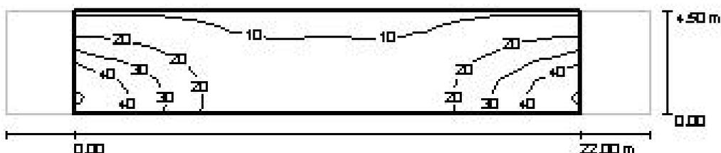
Figura 5.9 – Illuminamento orizzontale medio – curve isolux.
