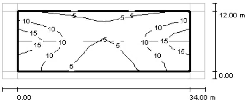
Figura 5.11 – Illuminamento orizzontale medio – curve isolux.
