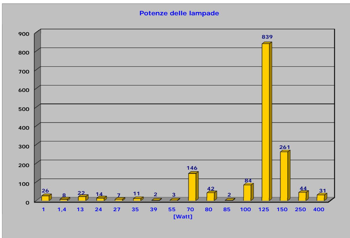
Figura 4.3 -potenze elettriche delle sorgenti luminose installate.
