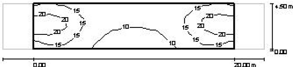
Figura 5.7 – Illuminamento orizzontale medio – curve isolux.
