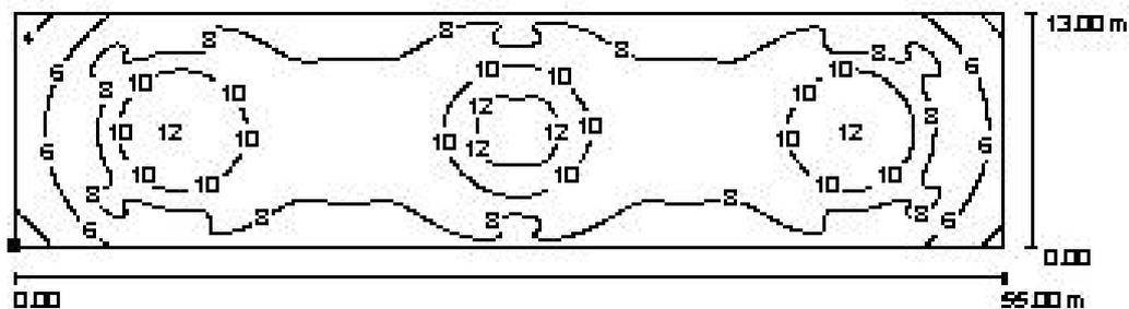
Figura 5.17 - Illuminamento orizzontale medio - curve isolux.
